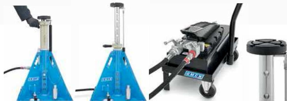
Sollevatore composto da pompa idropneumatica e due colonnette idrauliche, portata 10 ton ciascuna, con funzionamento in coppia o indipendente una dall'altra. Colonnette dotate inoltre di sistema manuale di variazione dell'altezza minima. La soluzione ideale per il sollevamento libera ruote dei veicoli pesanti e per un rapido intervento sugli stessi.
